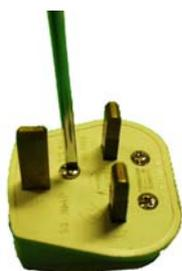
Löse die Schraube in der Mitte und entferne die Abdeckung.
