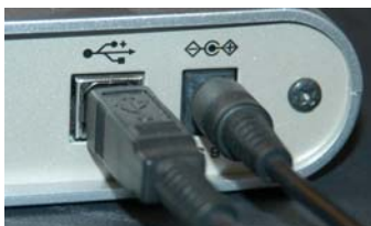
Convertorul Digital Video este conectat la calculator printr-un cablu USB
